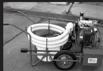
町婦人消防協力隊に整備された軽可搬ポンプ
